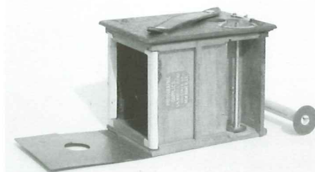
Het binnenwerk van de No. 2 Bullet, model van 1895, gezien van opzij. Goed zichtbaar is het compartiment voor de opwindspoel, gelegen vlak achter het frontpaneel waarop de sluiters is gemonteerd. Een lege spoel ligt naast de camera. Door de holle houten kern van de spoel wordt de sleutel gestoken.
