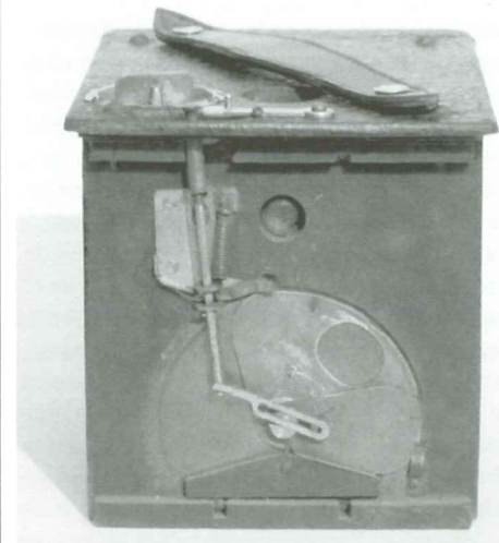
Het sluitmechanisme van de No. 2 Bullet, model van 1895. Deze sluiters is ontworpen en geïmplementeerd door Frank Brownell. De Kodak Bullet wordt vaak verward met de Boston Bulls-eye, maar kan gemakkelijk herkend worden aan deze sluiters.
