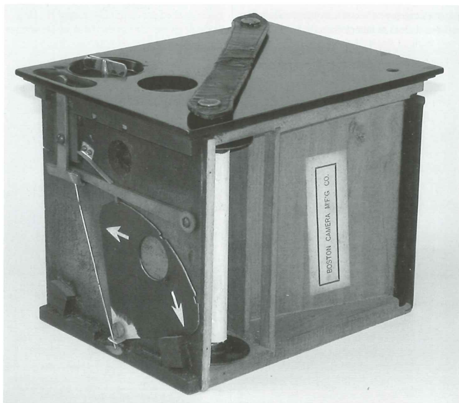
De constructie van de Boston Bull's-Eye is in deze foto goed zichtbaar. De voorraadspool en opwindspool bevinden zich vlak achter het front. De sluiters is zeer eenvoudig, maar werkt soepel.
